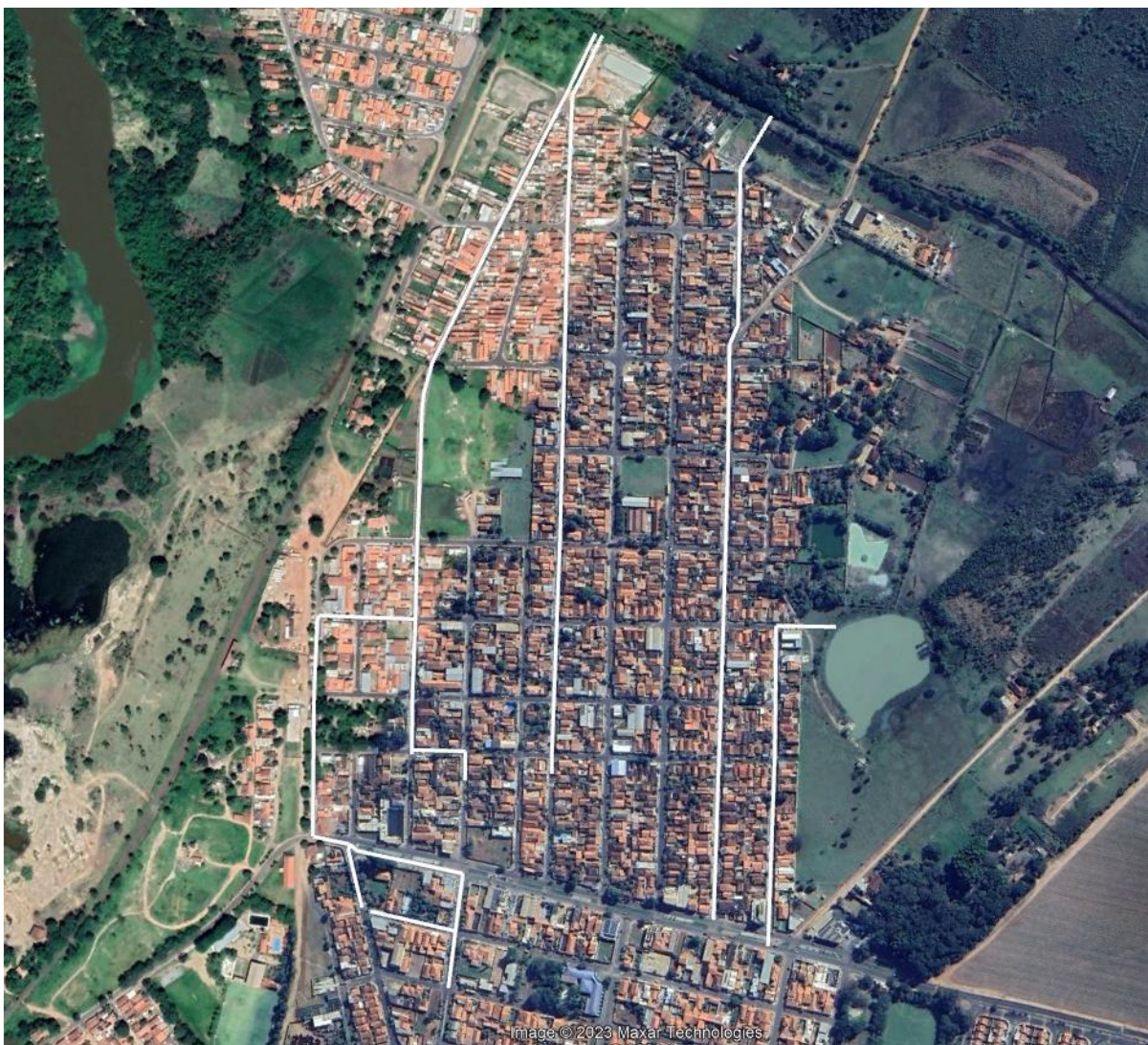
Figura 7. Principais redes de drenagem de guas pluviais urbanas nos bairros Centro e Maria Luiza
